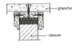
Liaison cloison-plancher (extrait des règles PS-MI)
